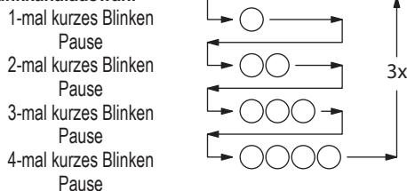
Diese Blinksequenz wird 3 mal wiederholt beginnend bei 1 mal kurz blinken. Erfolgt keine Betätigung der Taste
