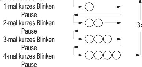
Diese Blinksequenz wird 3 mal wiederholt beginnend bei 1 mal kurz blinken. Erfolgt keine Betätigung der Taste
